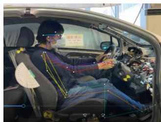
図2 ブレーキ操作をデジタル化できる技術
