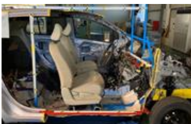
図1 ドライバの運転動作を計測する実験装置の構築
